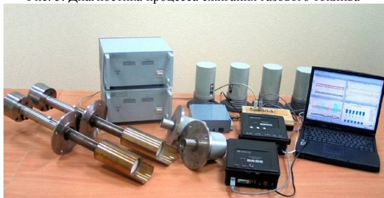
Рис. 6. Многоспектральные (УФ, видимый, ИК) датчики и газоанализаторы системы
