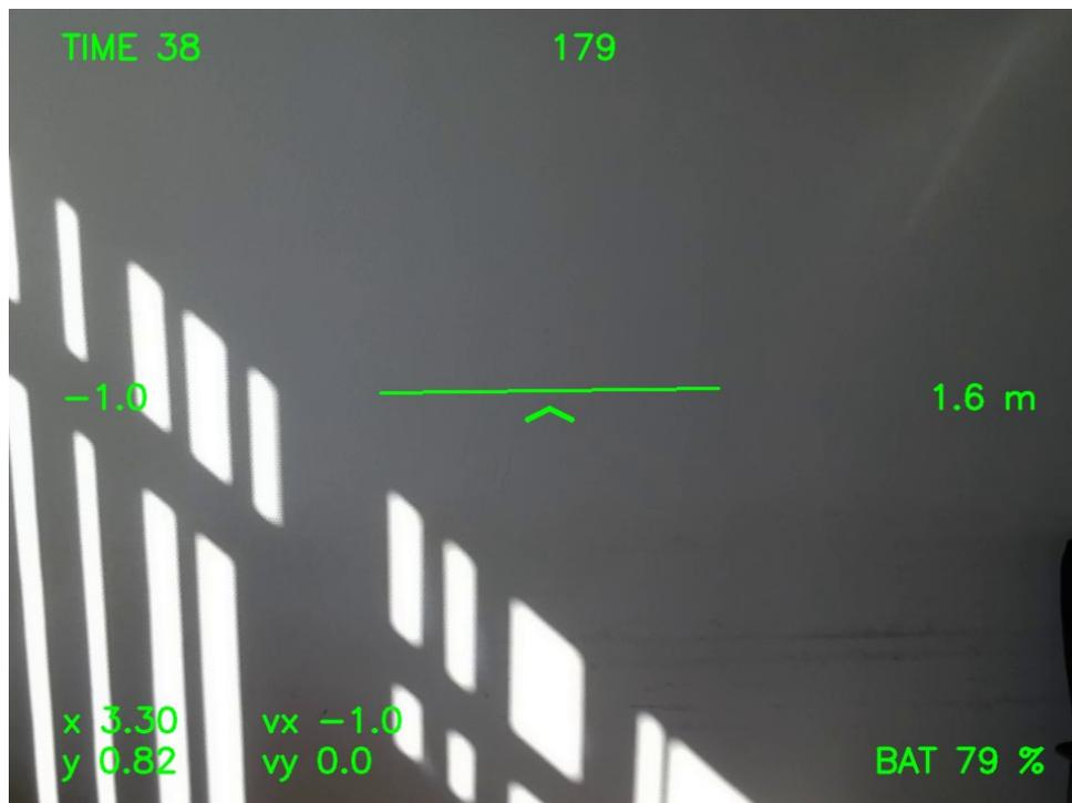
Рис. 5. Интерфейс оператора квадрокоптера Tello
