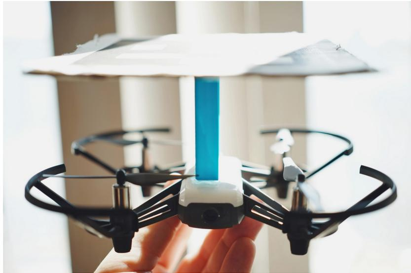
Рис. 3. Квадрокоптер Tello с закрепленным сверху AR-маркером
