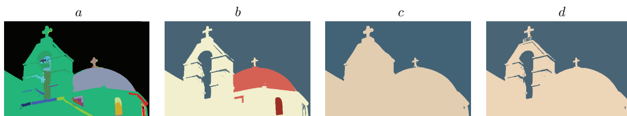
Рис. 5. Карты сегментации, полученные различными алгоритмами слияния суперпикселей при \gamma = 0 : a — базовым алгоритмом; b — «жадным» алгоритмом с условием минимизации расстояния в цветовом пространстве; c — «жадным» алгоритмом с условием минимизации информационной меры; d — «жадным» алгоритмом с условием минимизации комбинации расстояния в цветовом пространстве и информационной меры
