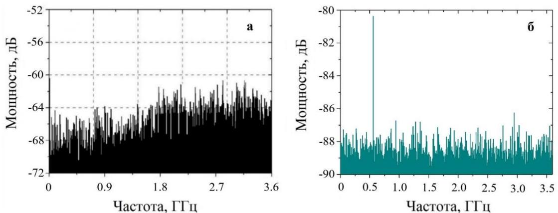
Рис.3.(а) Радиочастотный спектр РОС-лазера на основе резонатора, изготовленного с применением поточечной фс методики, при максимальной выходной мощности. (б) Радиочастотный спектр РОС-лазера на основе резонатора, изготовленного с применением голографической методики и непрерывного ультрафиолетового излучения, при максимальной выходной мощности.
