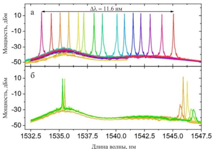
Рис.8 Перестройка длины волны СРОС-лазера в конфигурации с полуоткрытым резонатором на основе волокна НЦВО 1.2 мол. %  $\text{Er}^{3+}$ : (а) одноволновой и (б) многоволновой режимы работы.
