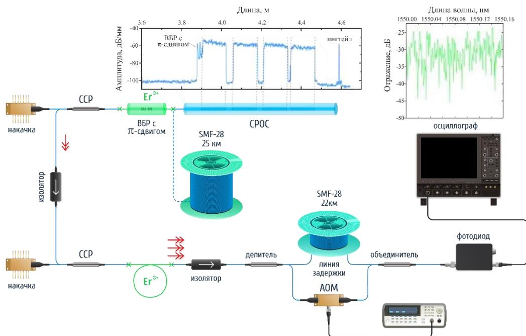
Рис. 5. Экспериментальная схема эрбиевого лазера с составным резонатором и измерительным стендом.
