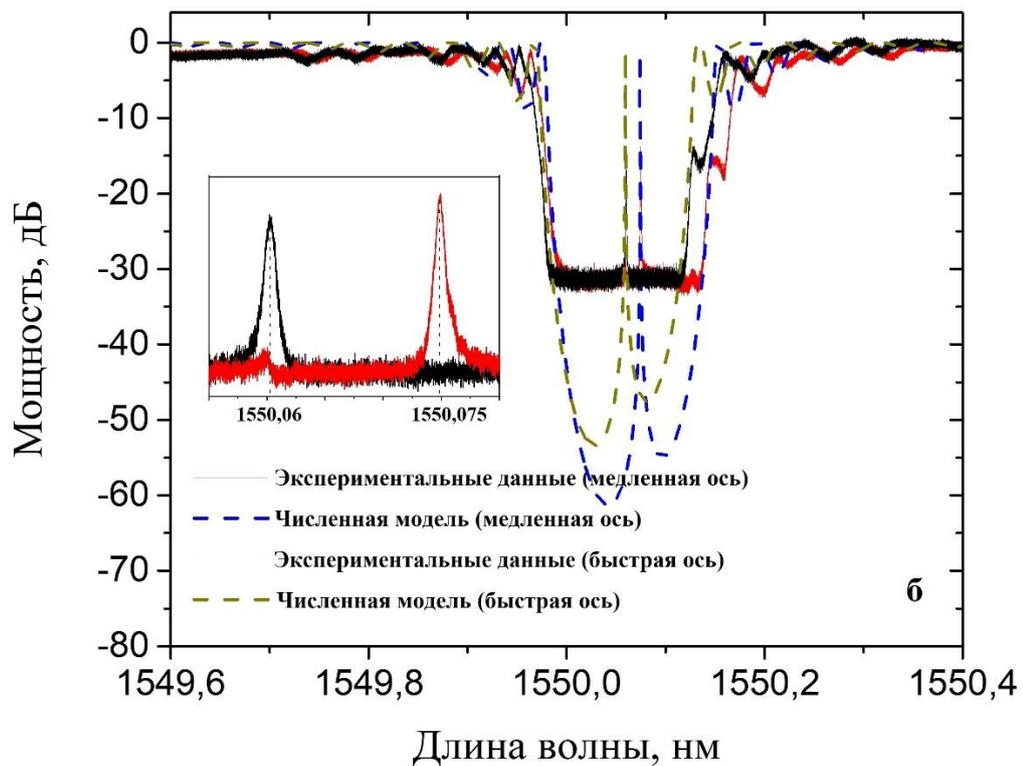
Рис.1. (а) Схема резонатора волоконного лазера с распределенной обратной связью (б) Спектр пропускания  $\pi$ -ВБР в ортогональных поляризациях (с увеличением в области  $\pi$ -сдвига). Непрерывными линиями обозначены экспериментальные значения, пунктирными линиями представлено численное моделирование.
