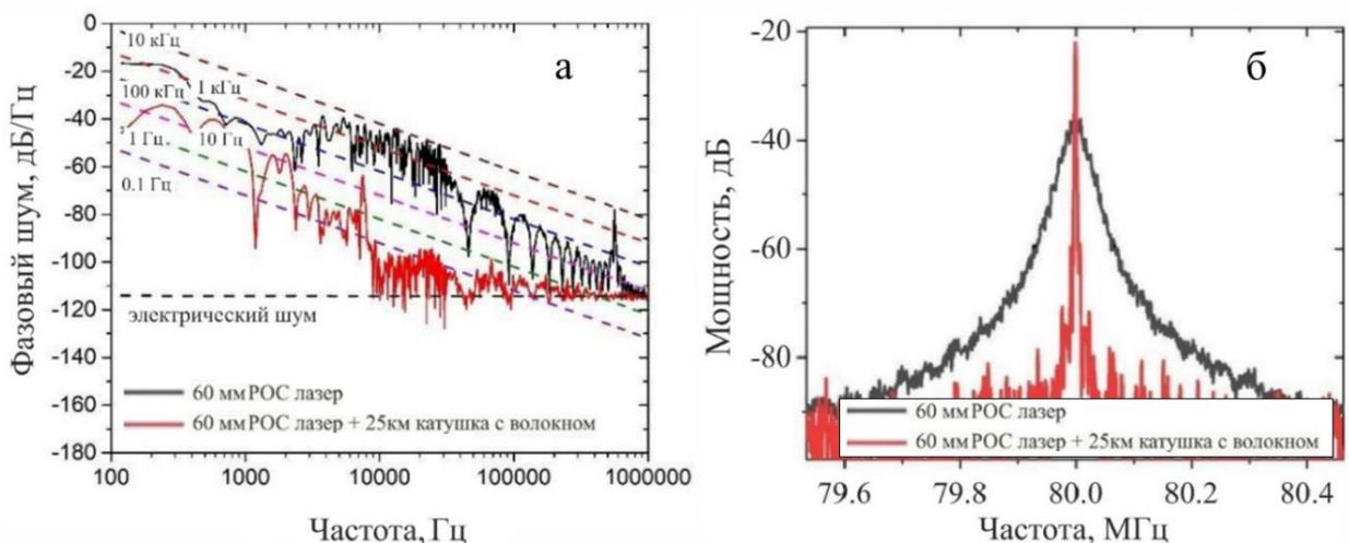
Рис. 6. (а) Спектр фазового шума для 60-мм РОС-лазера (черный цвет) и РОС-лазера с составным резонатором (красный цвет). (б) Радиочастотные спектры биений РОС-лазера (черный цвет) и РОС-лазера с составным резонатором (красный цвет), полученные с применением методики самогетеродинамирования.
