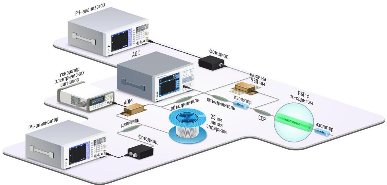
Рис.2. Схема РОС-лазера и сопутствующего измерительного оборудования.
