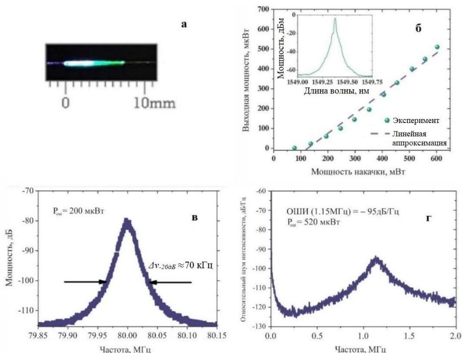
Рис.4. (а) Фотография резонатора РОС-лазера в процессе накачки. (б) Зависимость выходной мощности излучения от мощности накачки, вставка: спектр генерации при максимальной мощности излучения.
