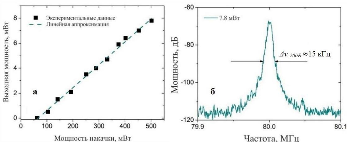
Рис.7. (а) Измеренная выходная мощность в зависимости от мощности накачки. (б) Спектр радиочастотных биений, полученный с применением методики самогетеродинамирования (кольцевая схема).
