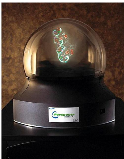
Рисунок 1.7 – Волюметрический 3D экран компании Actuality Systems в модели Perspecta
