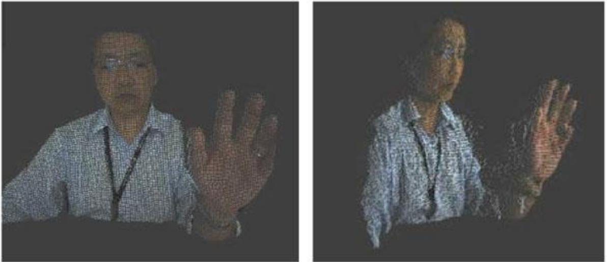
Рисунок 1.5 – Кадр 3D изображения, полученный ToF камерой с разрешением  $290 \times 257$  пикселей на кадр
